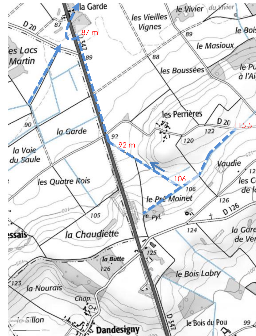
Figure 12 : Fossés principaux à l'amont et à l'aval de la RD la RD 347 avec cotes NGF
