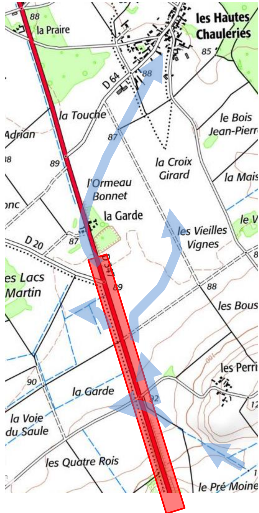
Figure 27 : Schéma des écoulements principaux en cas d'événements exceptionnels, accès d'urgence et situation cadastrale
